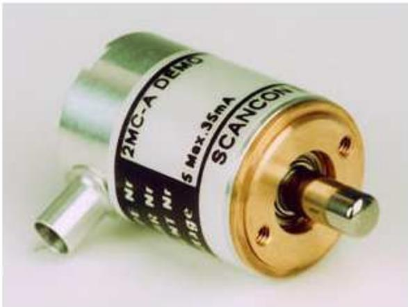
Les codeurs rotatifs sont des capteurs de position angulaire. Le disque du codeur est solidaire de l'arbre tournant du système à contrôler. Il existe deux types de codeurs rotatifs, les codeurs incrémentaux et les codeurs absolus.
